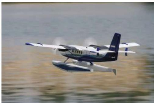
Au décollage il faut combattre l'effet de succion qui tend à maintenir l'avion plaqué à la surface, ce qui passe par une phase de transition où les flotteurs déjaugent qui permet la prise de vitesse nécessaire au décollage.
